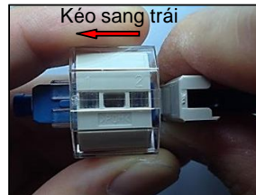
Lấy sợi cáp ra khỏi cable holder
